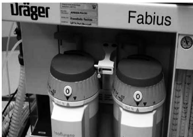
Рисунок 1. Переключатель-блокиратор расположен между испарителями
