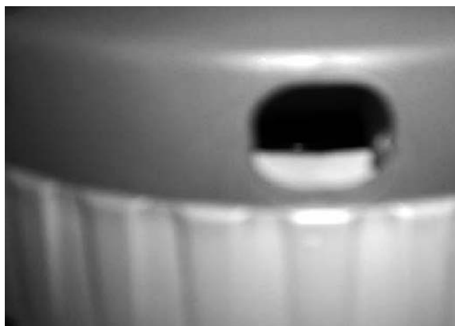
Рисунок 2. Галотановый испаритель с отсутствующим ограничителем
